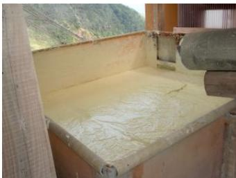
②樋より専用のパイプラインで水切り枺へ送られ、湯の花の水分を粗方切る。
