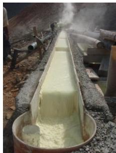
①約20mの樋にゆっくりと温泉を流し、湯の花を沈殿させる。
