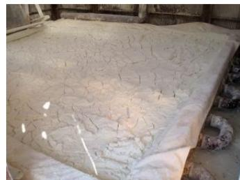
③水切り枺より乾燥小屋へ移され温泉の熱を利用して、湯の花を乾燥させる。
